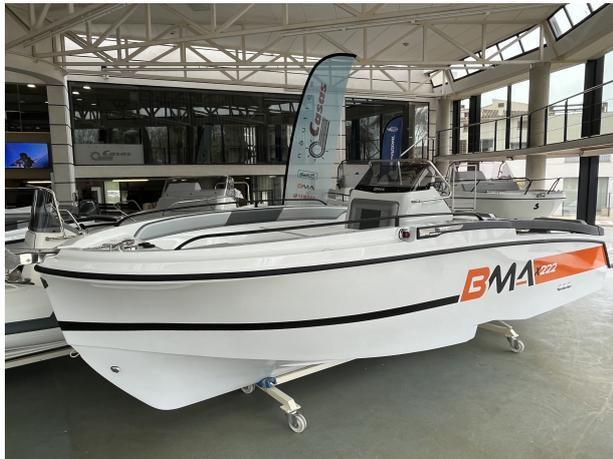
Cornamusas acero sport, extractor gases, consola con asiento, pasamanos en acero inox lacado, luces navegación, roldana proa, bomba achique automática, escalera de baño, asiento piloto sport, deposito de combustible de 190 l., desconectador de baterías, tapicería sport, dirección hidráulica, volante sport, compas, bocina.
